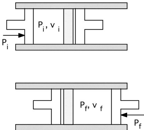
Usando el Primer Principio de Termodinámica se tiene  $\Delta U = Q + W$ , pero  $Q = 0$ . El trabajo recibido por el gas es el realizado por el pistón de la izquierda menos el recibido por el pistón
