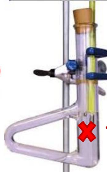
Es recomendable que el termómetro y la muestra se coloquen en el punto medio de las corrientes de convección
