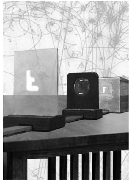
El objeto es una abertura en forma de F en una caja dentro de la que hay una bombilla (derecha de la figura). La luz que le llega a la lente en el centro produce una imagen en una pantalla (izquierda de la figura), imagen que es real, invertida y mayor que el objeto.
