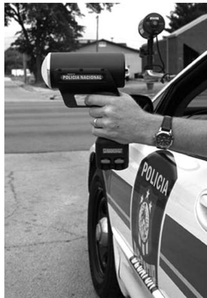
Una fuente emite ondas electromagnéticas hacia un móvil. De acuerdo con la frecuencia con que regresen a la fuente, se puede conocer la rapidez del móvil. Este es uno de muchos ejemplos de aplicación del *efecto Doppler*.
