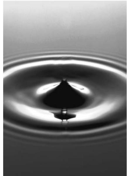
La onda se propaga en varias direcciones a partir de la fuente. En la figura los frentes de onda son circunferencias concéntricas cuyos puntos oscilan en fase.
