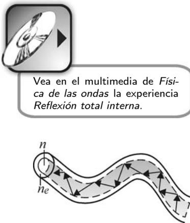
**Figura 16.4** En una fibra óptica,  $n > n_e$ .
