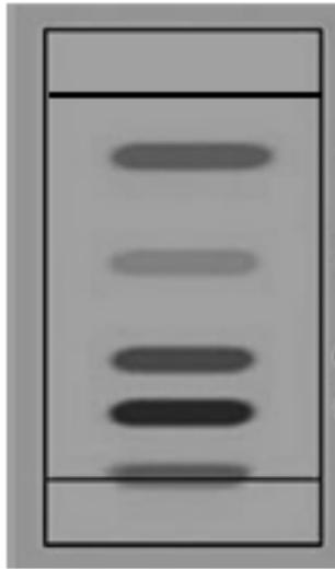
El siguiente cromatograma fue obtenido sobre una placa de sílica gel y corrido con una mezcla 2:10:30 de ácido acético, cloroformo y éter sulfúrico, respectivamente.
