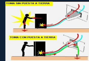
Falta de conexión a tierra
