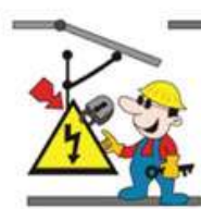
Bloqueo o enclavamiento de los aparatos de corte
