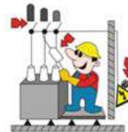
Detectar ausencia de tensión
