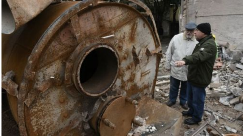
Las tres imágenes hacen referencia a la explosión de Caldera en Laboratorio Apolo, Rosario, 2016
