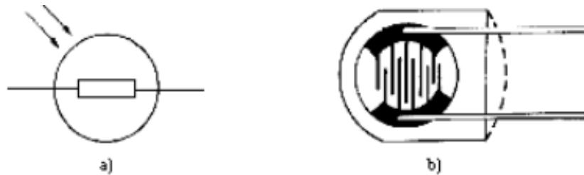
Fotorresistencia (LDR). a) Símbolo. b) Modelo de bajo costo, encapsulado en plástico transparente
