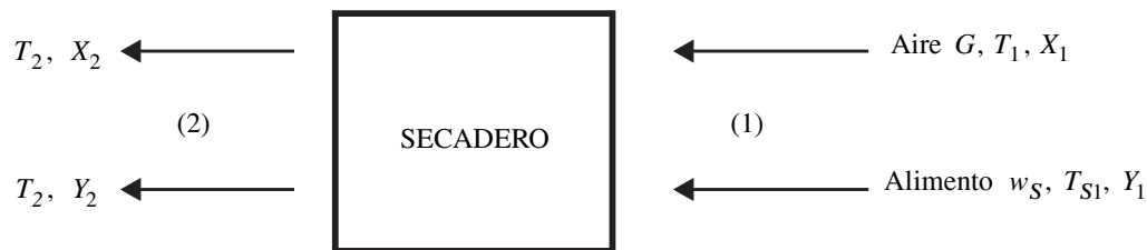
Figura 18.14. Operación de secado en equicorriente.
