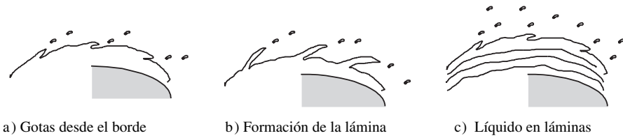
Figura 18.18. Atomización con discos sin paletas (adaptado de Barbosa-Cánovas y Vega-Mercado, 1996).
