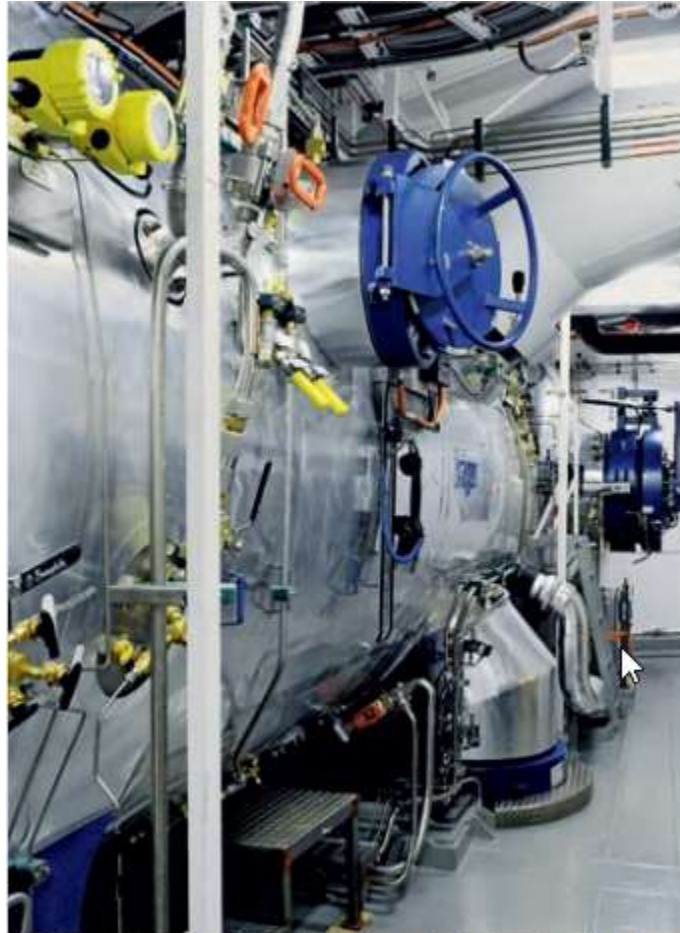
Vivir bajo presión: las cámaras hiperbáricas en las que viven los buceadores durante varias semanas son un componente principal del barco noruego Seven Havila
