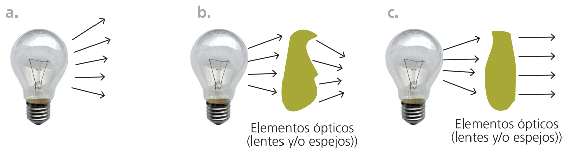
Figura 5.2. Los haces luminosos pueden estar constituidos por rayos divergentes(a), convergentes(b) o paralelos(c)
