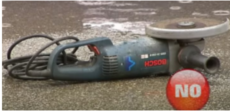
figura 7.4: Amoladora expuesta a la lluvia
