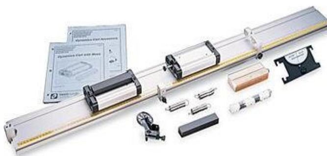
Figura 4. Pista (plano inclinado) y accesorios.
