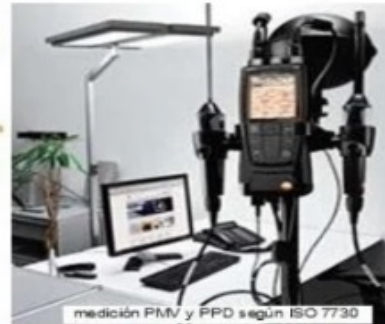
medición PMV y PPD según ISO 7730
