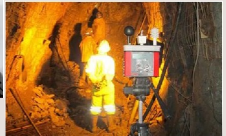
medición PMV y PPD según ISO 7730
