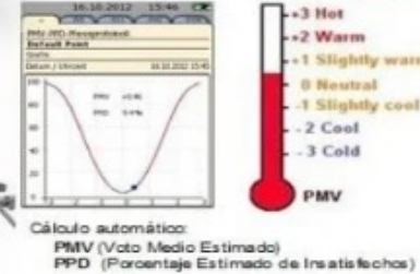
medición PMV y PPD según ISO 7730
