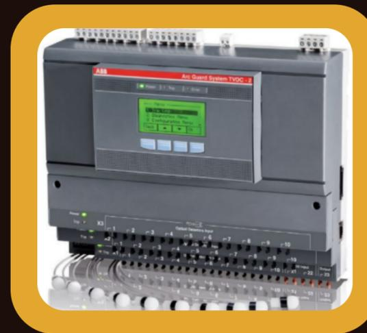
Están provistos de sensores ópticos o de presión que detectan la presencia de un arco interno en unos pocos milisegundos. Estos dispositivos electrónicos trabajan en tres etapas: detección, reconocimiento y acción para abrir los interruptores..
