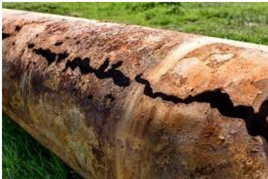
Figura 8: Corrosión tubería A
