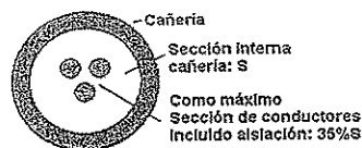
Figura 23-IX. Detalle de conductores en cañería
