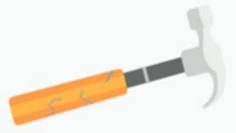
Nunca debe utilizarse un martillo con el mango deteriorado o reforzado mediante cuerdas o alambres
