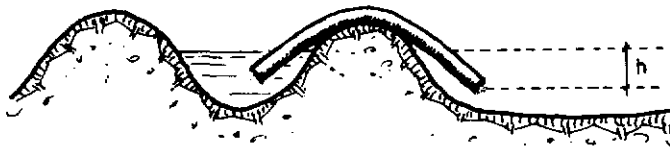
Fig. 8-13 Perspectiva de la derivación de la acequia a los surcos mediante sifones ( h es la altura hidrostática o carga hidráulica).
