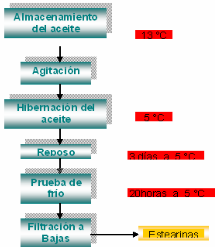
Diagrama 16. PROCESO DE WINTERIZACIÓN, ENFRIAMIENTO O HIBERNACIÓN DEL ACEITE BLANQUEADO
