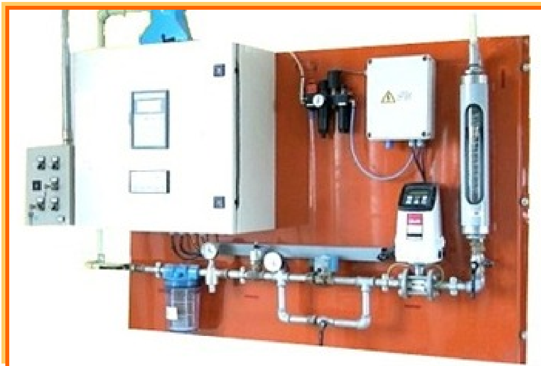
Figura 17. SISTEMA DE ROCIADOR DEL CEREAL AUTOMÁTICO CON MEDIDOR DE CAPACIDAD
