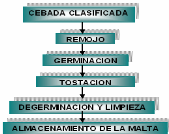
Diagrama 5. PROCESO PARA LA OBTENCIÓN DE MALTA
