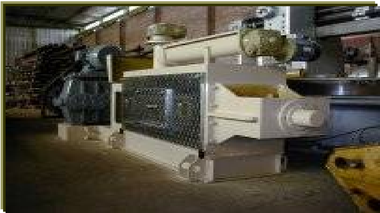
Figura 43. PRENSA DE PRESION TOTAL MASIERO MODELO PT-10 Capacidad: 1 tn/h (soja pre extrusada)
